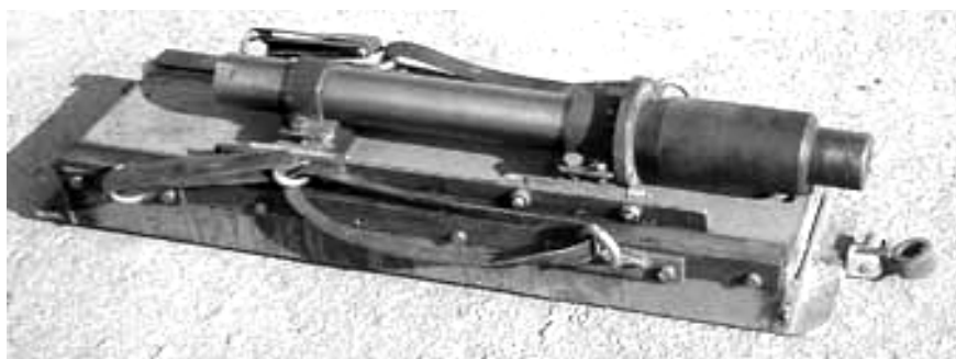
Рис. 2. – Пороховой импульсный водомет
