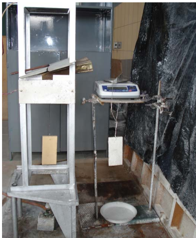
Рис. 1. Общий вид лабораторной установки для определения времени повторного воспламенения
