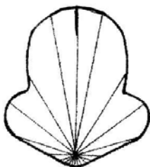
Рис.2.1. Диаграммы теплового облучения на рабочих местах плавки базальта и загрузки стекловарочной печи
