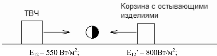
Рис. 4.9. Облученность рабочего места оператора от двух источников (источники 12 и 12а)
