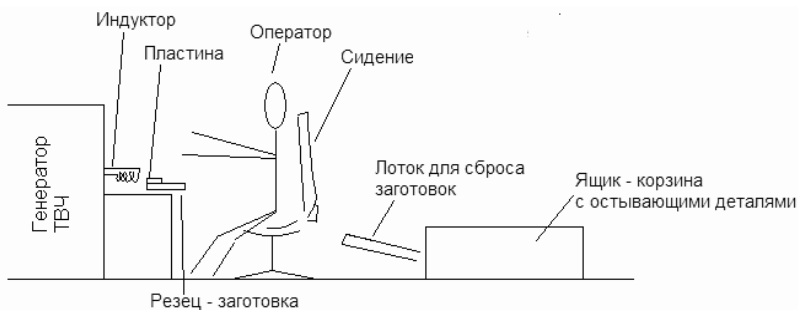
Рис. 4.1. Воздействие высоких температур на рабочее место оператора от установки ТВЧ (источник 11) при технологической операции – пайке
