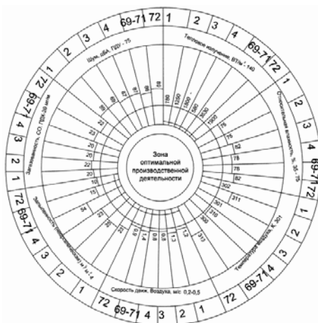
Рис.5.18 Диаграмма условий труда рабочих обжига кирпича и стекловарочного цеха – Ново-Александровка: 1 – обжиг кирпича в печи; 2 – выгрузка готовой продукции; 3 – контроль технологических параметров; 4 – внешний осмотр лючков и свода печи; 69-71 – загрузка-выгрузка при открытом окне; 72 – отпуск деталей
