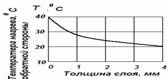
Рис. 3.43. Температура обратной стороны образца в зависимости от толщины теплозащитного слоя
