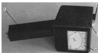
Рис.3.25. Прибор для определения энергосберегающих свойств строительных материалов: 1 – корпус; 2 – ручка прибора; 3 – приемник ИК-излучения; 4 – переключатель прибора на измерение; 5 – миллиамперметр.
