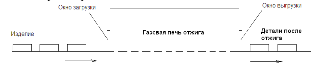
Рис.5. Схема отжига стеклопластиковых изделий.
