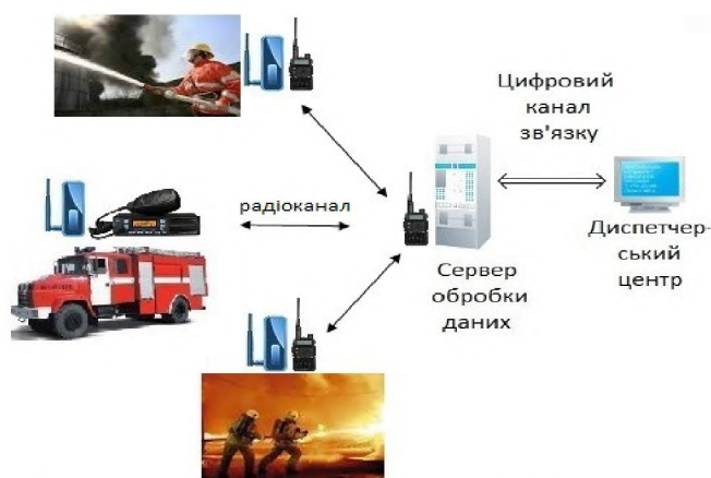
Рис. 1. Передача даних GPS-трекерів по радіоканалам управління
