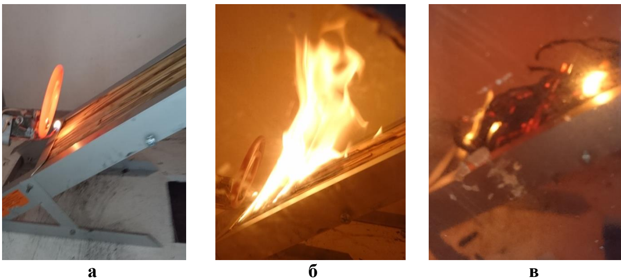
Рис. 2. Результати випробувань процесу займання та поширення полум'я необробленого очерету: а – вплив полум'я на зразок, б – займання зразка, в – горіння очерету
