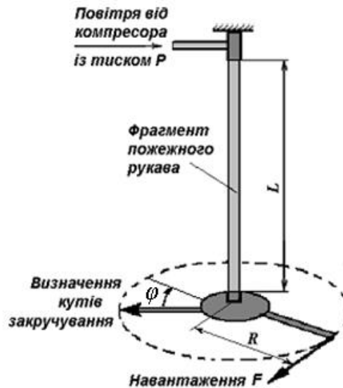
Рис. 1. Дослідна установка зі встановленим фрагментом рукава
