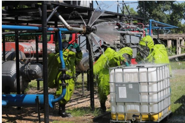
Рис. 2. Тренажер для відпрацювання вправ з ліквідації хімічно-небезпечних розливів речовин з трубогонів чи ємностей
