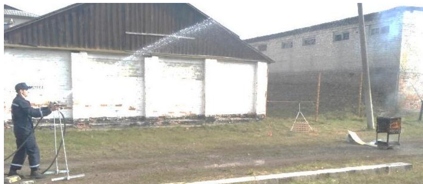
Рис. 3 Гасіння модельного вогнища 1А водою з використанням експериментальної установки АУГГУС-М
