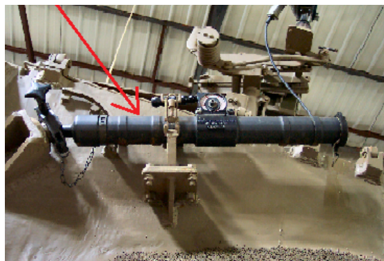
Рисунок 3 – Міномет калібру 60-мм "Soltam" на башті танка "Меркава Mk.1" (міномет вказаний стрілкою) [6]
