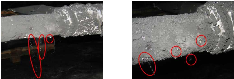
Рис. 2 – Результаты испытаний трубопроводной сборки D = 40 мм с проведением контроля протечек воды при гидравлическом давлении равному 0,15 МПа и 0,2 МПа (средняя скорость протечки воды не превышает допустимое значение регламентируемое методикой испытаний):
