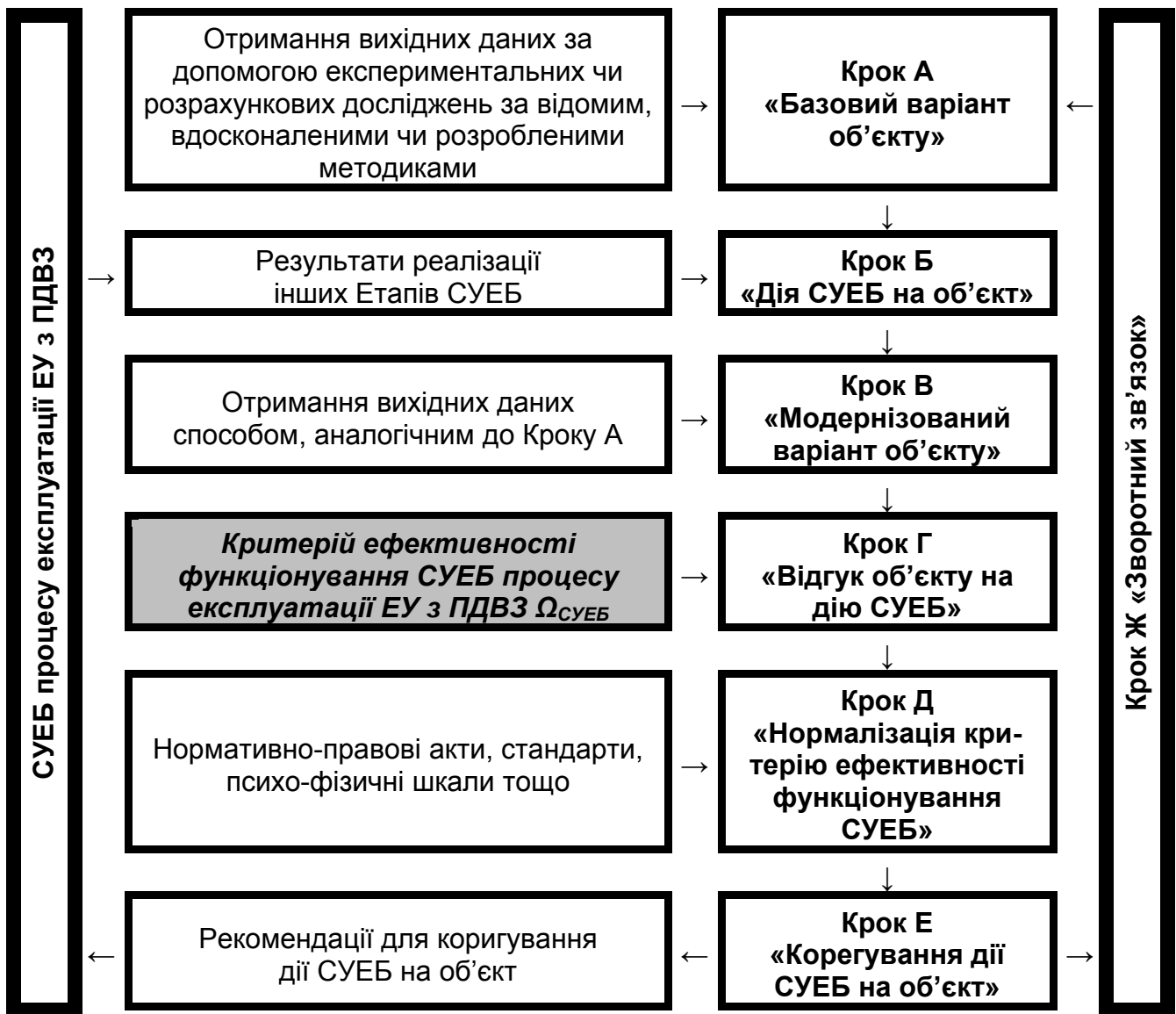
Рис. 1.1.6 – Алгоритм оцінки ефективності функціонування СУЕБ процесу експлуатації ЕУ з ПДВЗ
