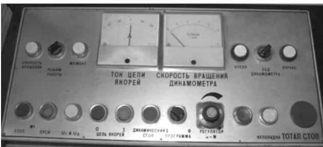
Рис. 1.3.1 – Моторний випробувальний стенд: а – загальний вид стенду; б – пульт керування стендом; в – навантажувальна машина з динамометром [А.1]
