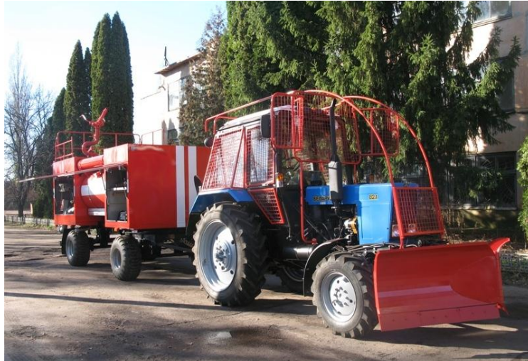
Рис. 3.43. Загальний вигляд агрегату пожежного універсального АПУ-1,4-178 в складі з причепом-цистерною пожежною ПЦП-3,5-40
